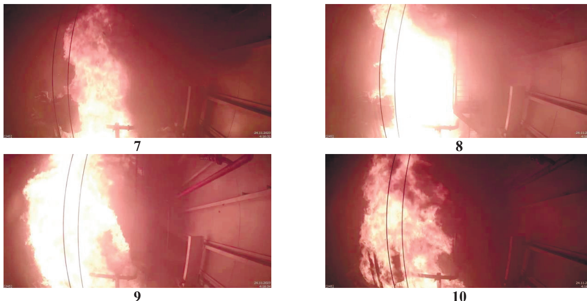
Рис. Мгновенные фотографии аварийного взрыва высоковольтного маслонаполненного электрооборудования (ВМЭО), которое находится в помещении
