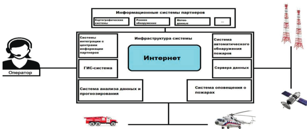
Рис. 1. Архитектурная схема работы системы «Лесной дозор»
