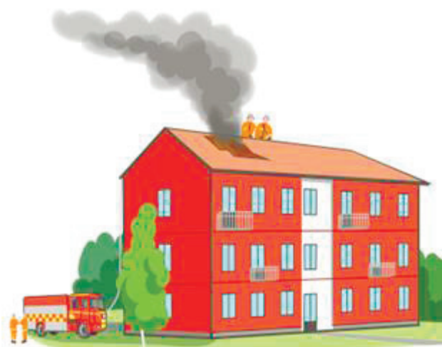
Рис. 1. Работа вертикальной вентиляции. Вид снаружи
