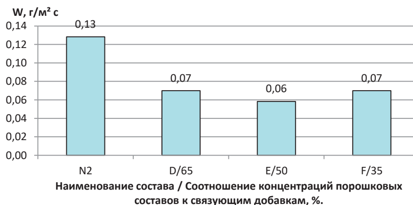
Рис. 1. Гистограмма зависимости интенсивности испарения \text{N}_2 в зависимости от порошковых составов на основе кварца пылевидного
