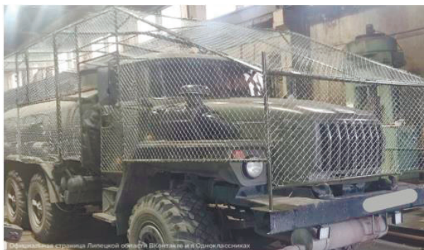
Рис. 3. Пример защиты с использованием металлических модульных конструкций
