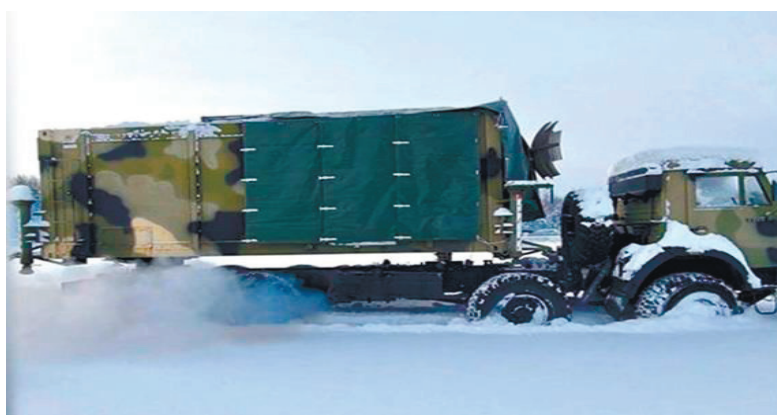
Рис. 2. Пример защиты кузова композитными материалами
