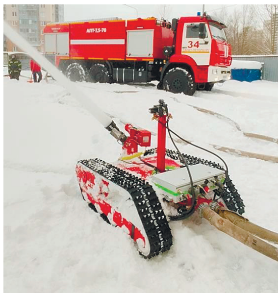
Рис. 2. Испытания мобильного РТК для пожаротушения «Фрезе» в зимних условиях. Хорошо видно, что подключено два пожарных рукава
