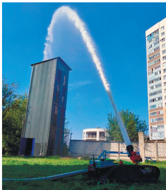
Рис. 1. Испытания мобильного РТК для пожаротушения «Фрезе». Ствол ДУЛС поднят максимально вверх, струя сплошная
