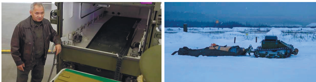
Рис. 1. Наземные робототехнические комплексы (НРТК), помогающих выполнять боевые задачи, эвакуировать раненых с передовой, а также подвозить тяжелые грузы к позициям
